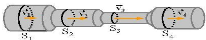
Зависимость скорости течения жидкости от площади сечения трубы.
